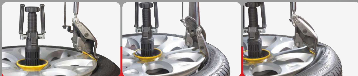
Procedura demontażu górnej stopki opony
