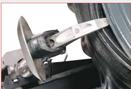
faza demontażu opony
